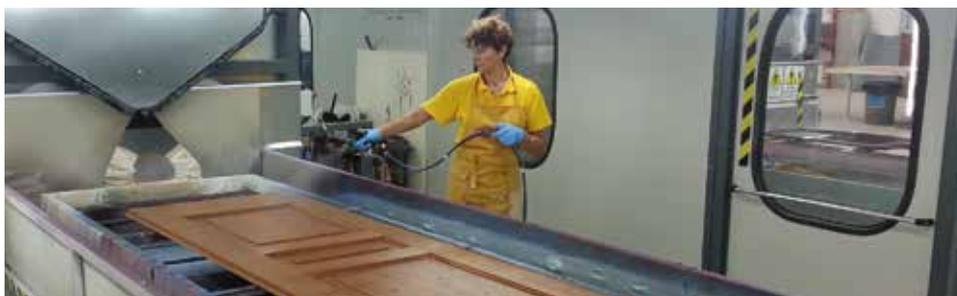
2 – All'interno di una delle cabine, si distinguono i telai che trasportano i pannelli, sia nella fase di verniciatura che nella fase di essiccazione.
