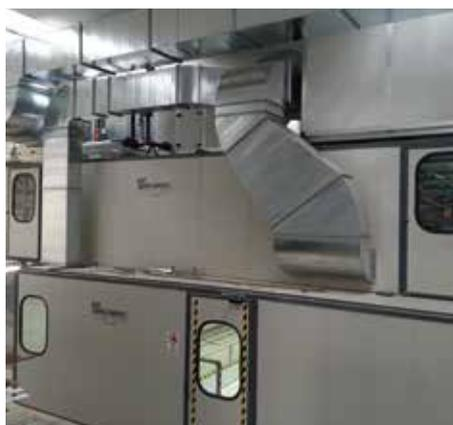
4 – Sopra la cabina è collocata la zona di essiccazione, condizionato e pressurizzato. The pressurised and conditioned drying area is positioned over the coating booth.
